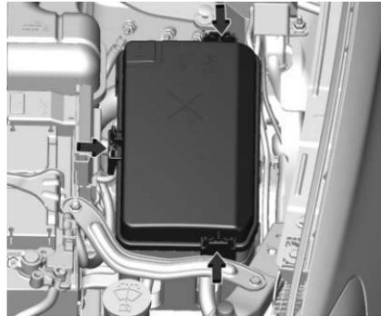
Para retirar la cubierta del bloque de fusibles, presione los seguros y gírela hacia arriba.
