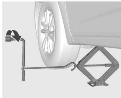
8. Eleve el vehículo, haciendo girar la llave para las ruedas en sentido de las manecillas del reloj. Eleve el vehículo a una altura tal, de manera que haya espacio suficiente para que la llanta usada no toque el suelo. No levante el gato más.
