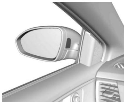
El sistema de alerta de punto ciego lateral detecta los vehículos en el punto ciego en los lados izquierdo y derecho del vehículo y proporciona alertas. Se muestra una señal de advertencia en el espejo retrovisor exterior para recordar al conductor que hay un vehículo en el punto ciego (el vehículo puede no ser visible directamente en los espejos interior y exterior).
