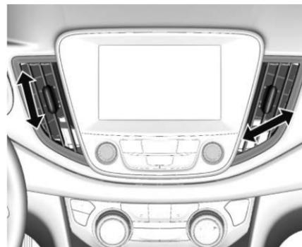
Mueva las perillas deslizables en las salidas de aire hacia arriba y hacia abajo o hacia la izquierda y hacia la derecha para dirigir el flujo del aire.
