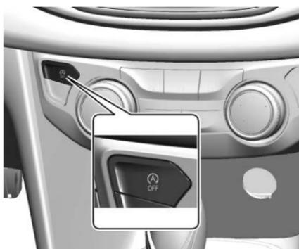
La función de arranque/paro automático del motor se puede desactivar y activar presionando el interruptor **(A) APAGADO**. El paro automático se activa cada vez que enciende el vehículo.
