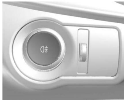
Las luces antiniebla traseras hacen el vehículo más visible desde la parte trasera en condiciones de niebla o neblina. Presione el botón para encender y apagar las luces antiniebla traseras. Las luces antiniebla traseras sólo se pueden encender cuando los faros están encendidos.
