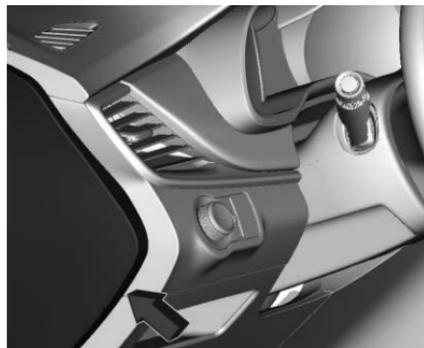
Retire la cubierta y reemplace el fusible.
