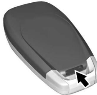
1. Separe las dos mitades del transmisor insertando una herramienta plana en el hueco del transmisor.
