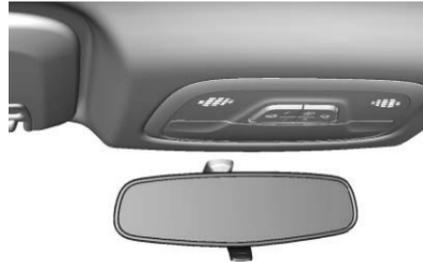
El espejo trasero interior completo se puede ajustar manualmente en las direcciones arriba, abajo, izquierda y derecha.
